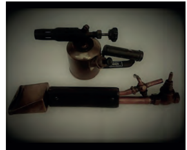
Gereedschap: Dakkant Soldeerder Beroep: Dakdekker
